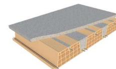
I blocchi sono dotati di alette laterali che fungono da base per il posizionamento delle armature aggiuntive inferiori e cassaforma per il getto in cls di completamento
