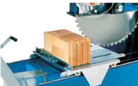
Taglio con idonea sega ad acqua. In alternativa sega a banco o motosega con lama per laterizio
