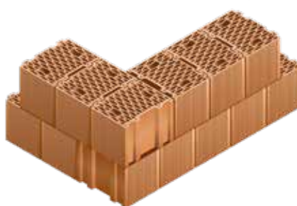
Ammorsamento d'angolo per blocchi di spessore 35, 38 e 40 cm
